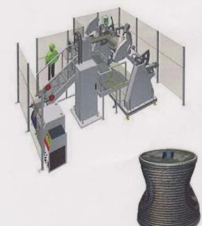
Possibilità di utilizzare sistemi di saldatura PLA-SMIG e PLASMATWIN con doppio alimentatore e doppia torcia independente
