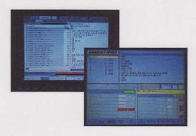
Con questa opzione attraverso il quadro comandi del controllo numerico si programma e si gestisce la saldatura, il movimento, l'eventuale sistema di preriscaldo,pulizia torcia ed ogni altro accessorio in tempo reale senza limitazioni.
